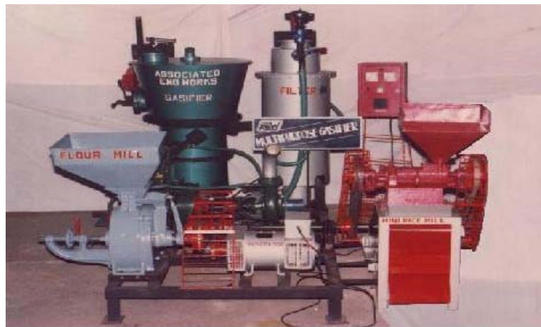
Unité de gazéification mixte avec alternateur, pompe d'irrigation, décortiqueuses et moulin.
