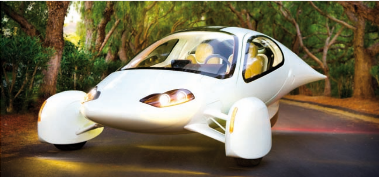
Figure 2.20 – La compagnie californienne Aptera Motors a mis sur le marché, en 2008, l’Aptera, un véhicule électrique à trois roues avec une autonomie de 200 km. L’Aptera peut transporter deux passagers avec une consommation minimale d’énergie et atteindre 140 km/h. (Source: Wikimedia Commons, auteur: Aptera Motors, juillet 2008)
