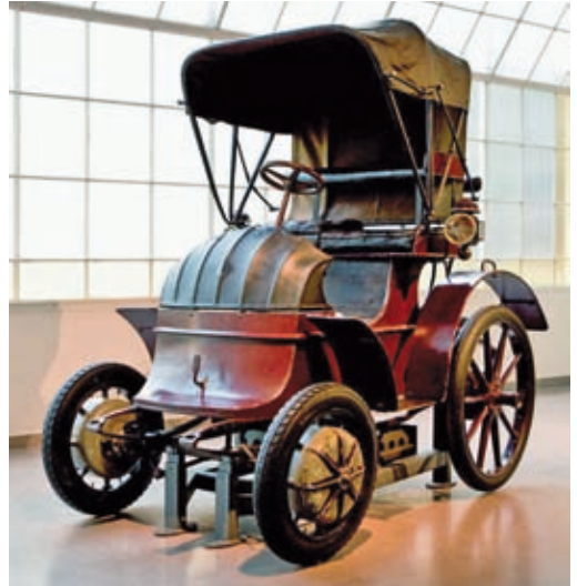
Figure 2.2 – Voiture électrique Porsche-Lohner à moteurs-roues construite en 1899 par le fabricant autrichien Lohner dont le groupe de traction a été conçu par Ferdinand Porsche. Source : Ultimatecarpage.com.
