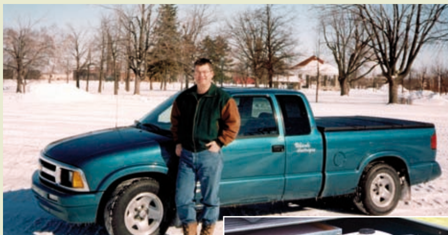
Figure 2.15 – Dès 1998, Alain Saint-Yves, spécialiste québécois en électrotechnique, a transformé une camionnette S-10 de Chevrolet en véhicule électrique qu'il a appelé Le Véhicule Vert. Ses batteries au plomb lui donnent une autonomie de 64 km. Sa vitesse maximale est de 104 km/h. Une génératrice à essence de 5 kW en prolonge l'autonomie à 120 km. Plus d'informations sur son site Internet: www.vehiculevert.org . (Photo: gracieuseté d'Alain St-Yves)
