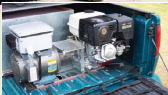
Figure 2.16 – Une génératrice de 5 kW agit comme prolongateur d'autonomie sur le Véhicule Vert d'Alain St-Yves. (Photo: gracieuseté d'Alain St-Yves)
