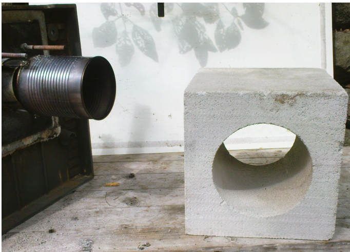
Prolongement du foyer en béton cellulaire
