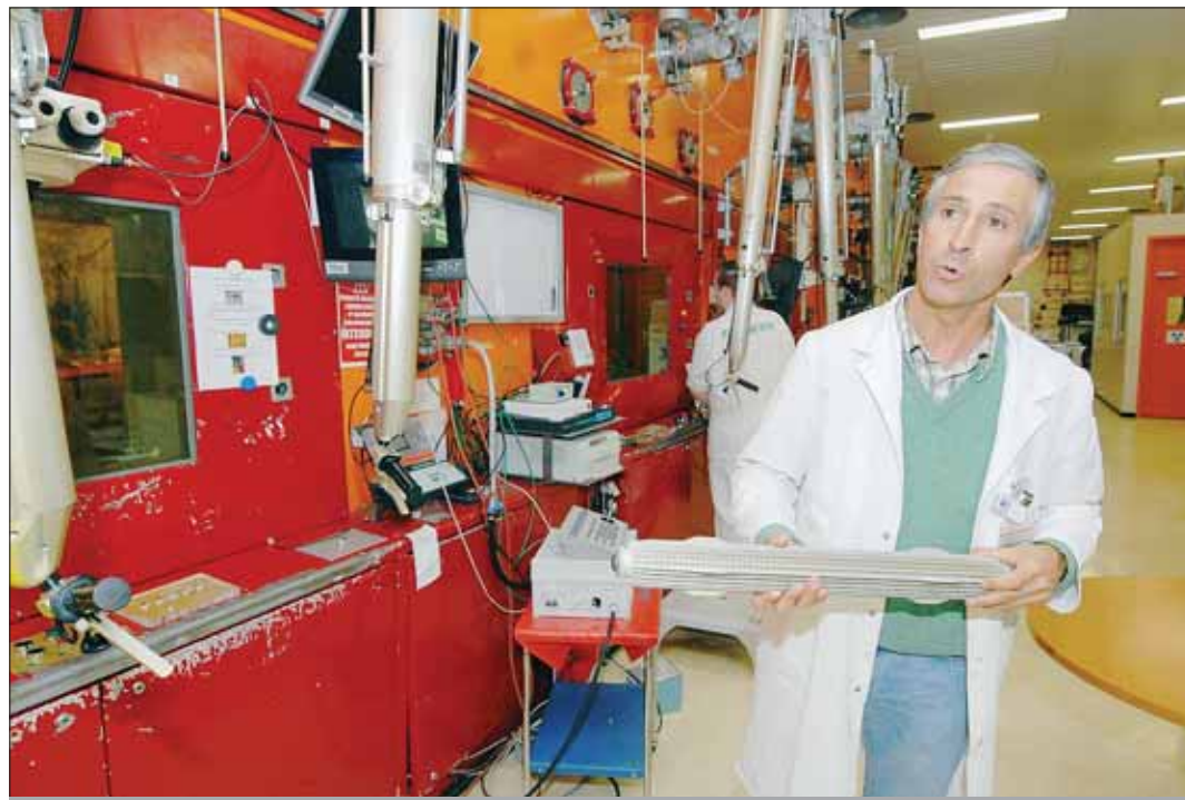
► Un des 80 chercheurs du CEA affectés au laboratoire Leca Star présente une gaine. Elle renferme le combustible qui doit être étudié dans les cellules qui sont derrière les vitrages. / PHOTO STÉPHANE DUCLET
