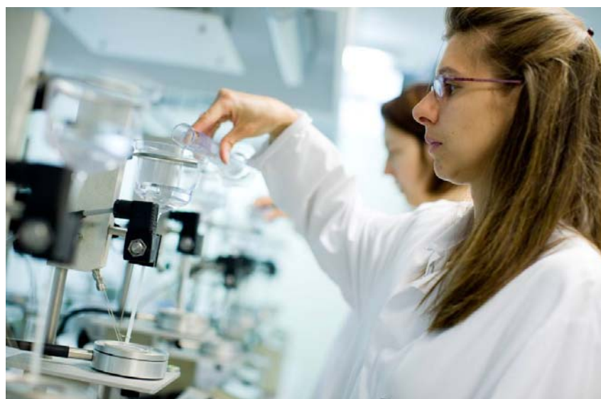
Laboratoire de traitement des échantillons. Evaporation d'eau sur coupelle pour analyses des émetteurs alpha et bêta -
