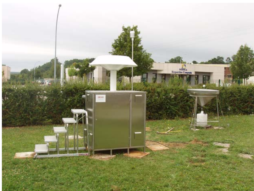
Station OPERA nouvelle génération (700 m 3 /h) + collecteur de retombées d'un m 2 installés sur le Centre Départemental Météorologique de Dijon - © IRSN
