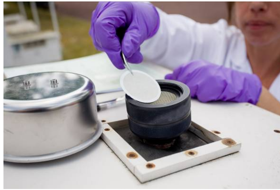
Prélèvement des aérosols sur filtre cellulose - Site du Vésinet - 26 juin 2008
