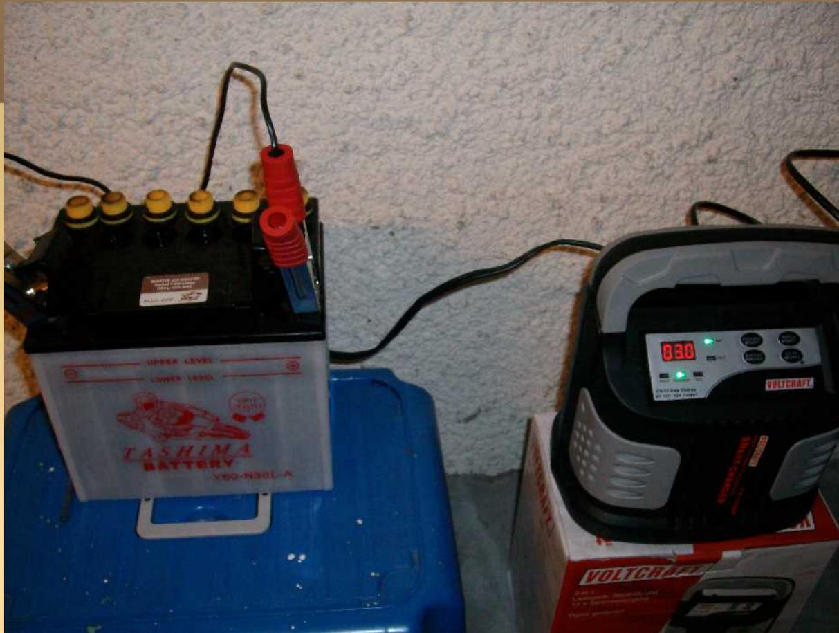
La batterie doit alors être chargée doucement en ne dépassant pas un courant de charge de  $1/10$  de sa capacité.
