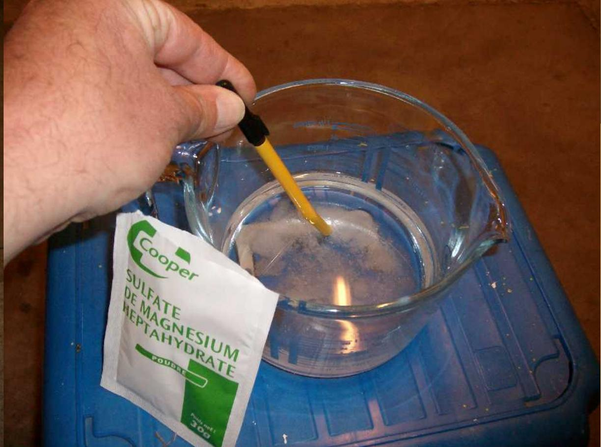
Une dose 30 grammes de sulfate de magnésium est dissoute dans l'électrolyte.
