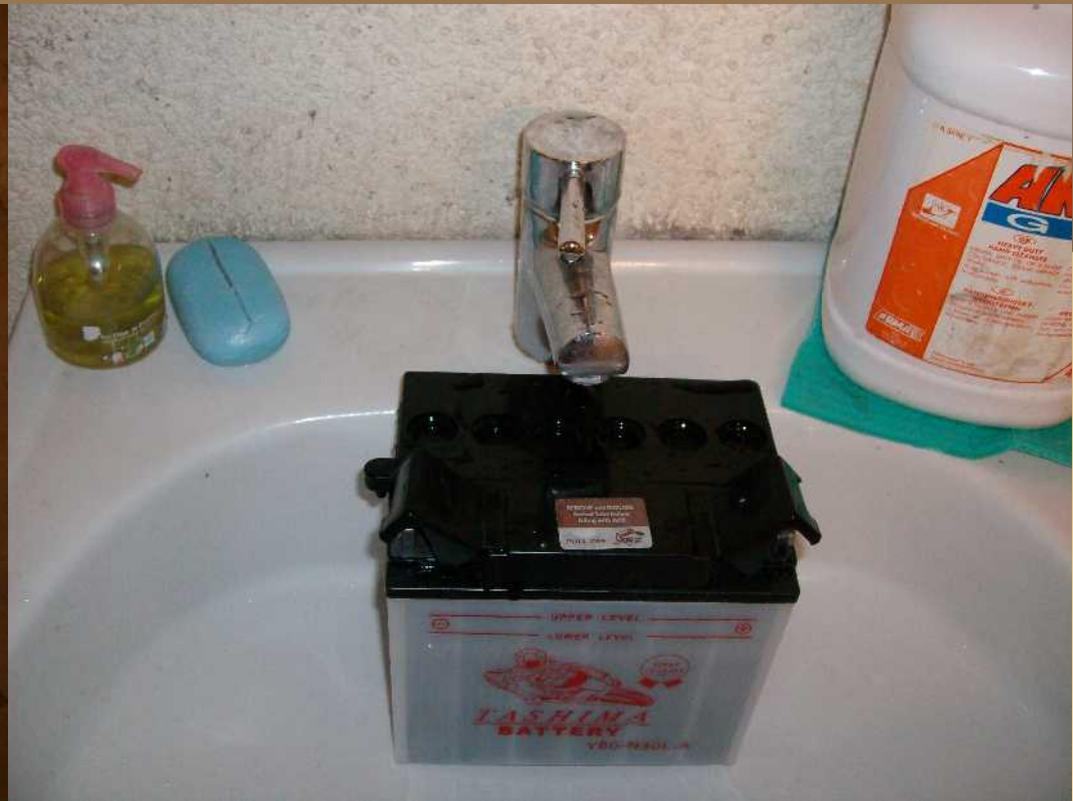
Après ces cycles de détartrage la batterie est vidée, rincée et est remplie avec de l'électrolyte neuf, l'électrolyte usagé est amené à la déchetterie aux cotés des batteries usagées.
