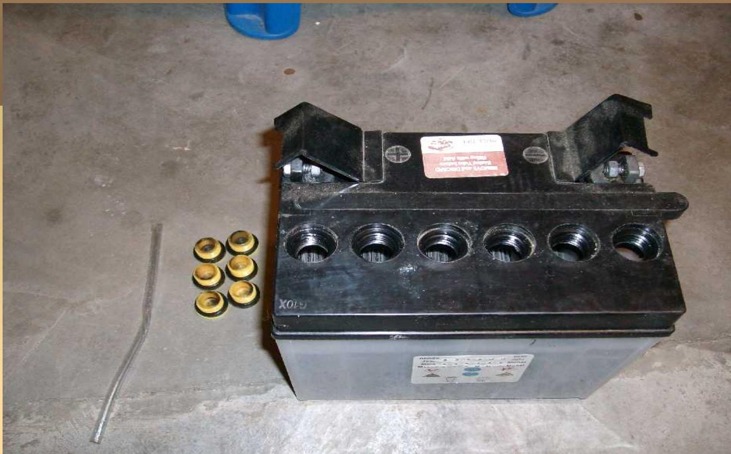
La batterie est démontée du groupe, dépoussiérée et les bouchons sont ôtés.
