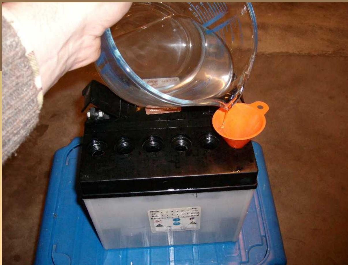
Remplissage de la batterie avec l'électrolyte et le sulfate de magnésium dissous.
