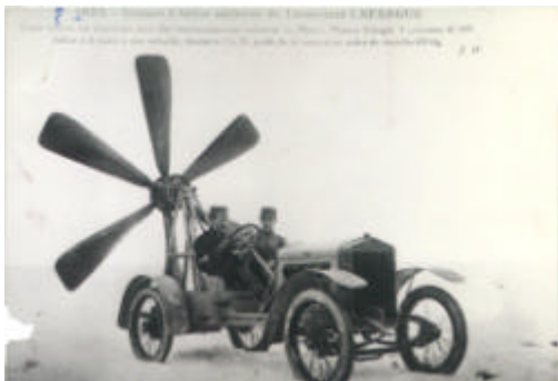
En 1922 est expérimenté dans le sable du désert saharien cette automobile à hélice aérienne mue par un moteur Clerget de récupération.
