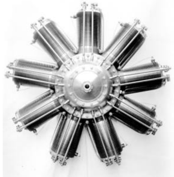
Moteur Clerget-Blin 9A de 110 ch (1914).
