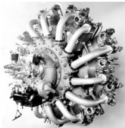
Diesel Clerget 14 Fcs vue par \frac{3}{4} arrière, moteur d'aviation suralimenté à double injection, homologué à 500 ch en 1937 et 600 ch en 1939.
