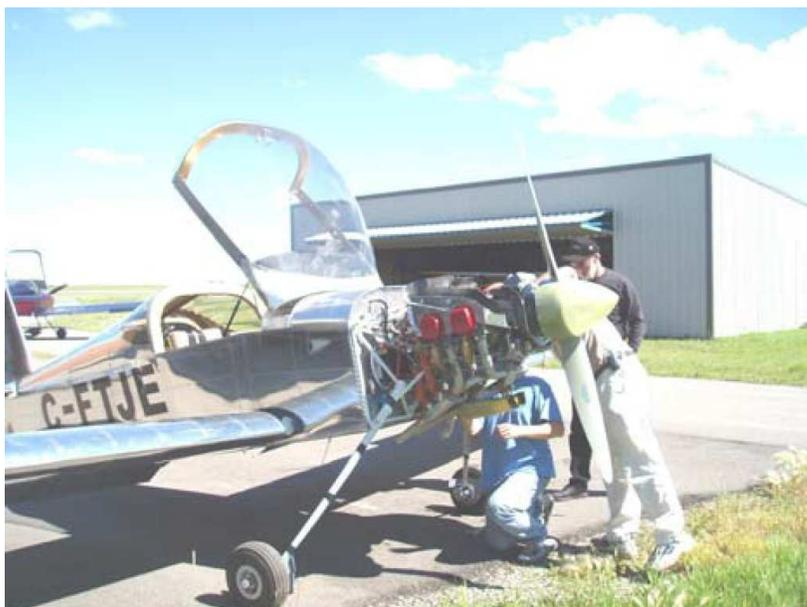
6. Pour le démarrage initial, laissez tourner le moteur à un ralenti rapide, (850 à 1000 RPM). Limitez l'opération à haute vitesse du moteur à 3 ou 4 minutes à 1800 RPM. Arrêtez et inspectez pour déceler les fuites d'huile possible. Pendant les essais de taxi et les courses au sol, ne dépassez pas les températures de culasse (CHT) de 400 °F, ou la température d'huile de 200 °F.
