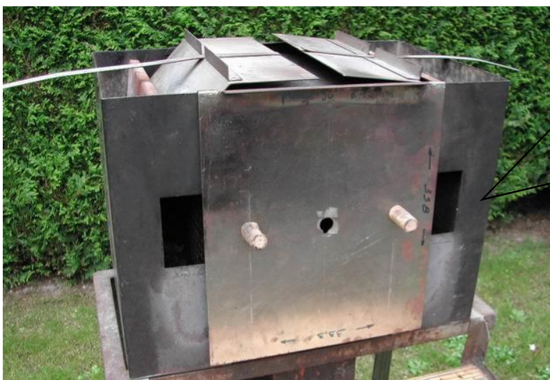
La cloison arrière et la porte sont identiques : fabrication simplifiée.
