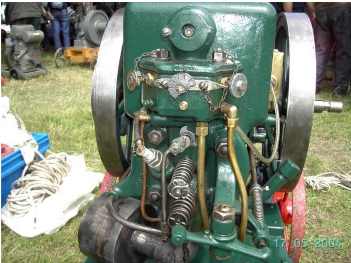
La magnéto alimentant la bougie est la « boîte » en laiton située à droite, à côté du volant d'inertie. On voit nettement le câble haute tension qui passe derrière la mystérieuse « boîte à boutons » (ou « mélangeur ») et aboutit sur la bougie.
