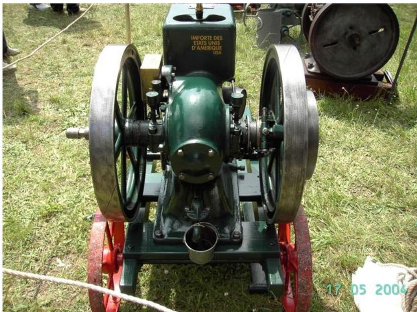
On voit d'ailleurs que l'utilisateur a placé un seau sous ce robinet pour récupérer le trop plein d'huile. La mention « importé des USA » dissipe tout malentendu. On remarque également le régulateur centrifuge à ressorts sur la poulie de droite, qui commande le papillon des gaz.
