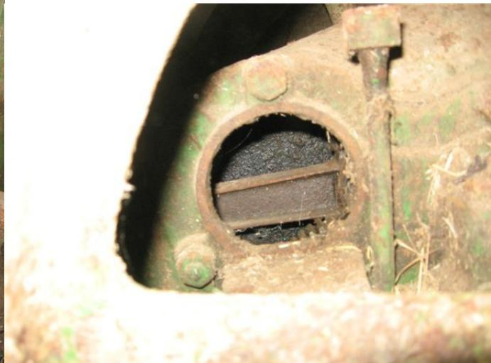
A gauche, l'emplacement de la bougie (au dessus du ressort de culbuteur) est masqué par le foin. A droite, le trou par lequel s'engrène la magnéto (vu à travers le volant d'inertie). On distingue la bielle et un engrenage, ainsi qu'un « plateau » sur lequel « reposait » cette magnéto.
