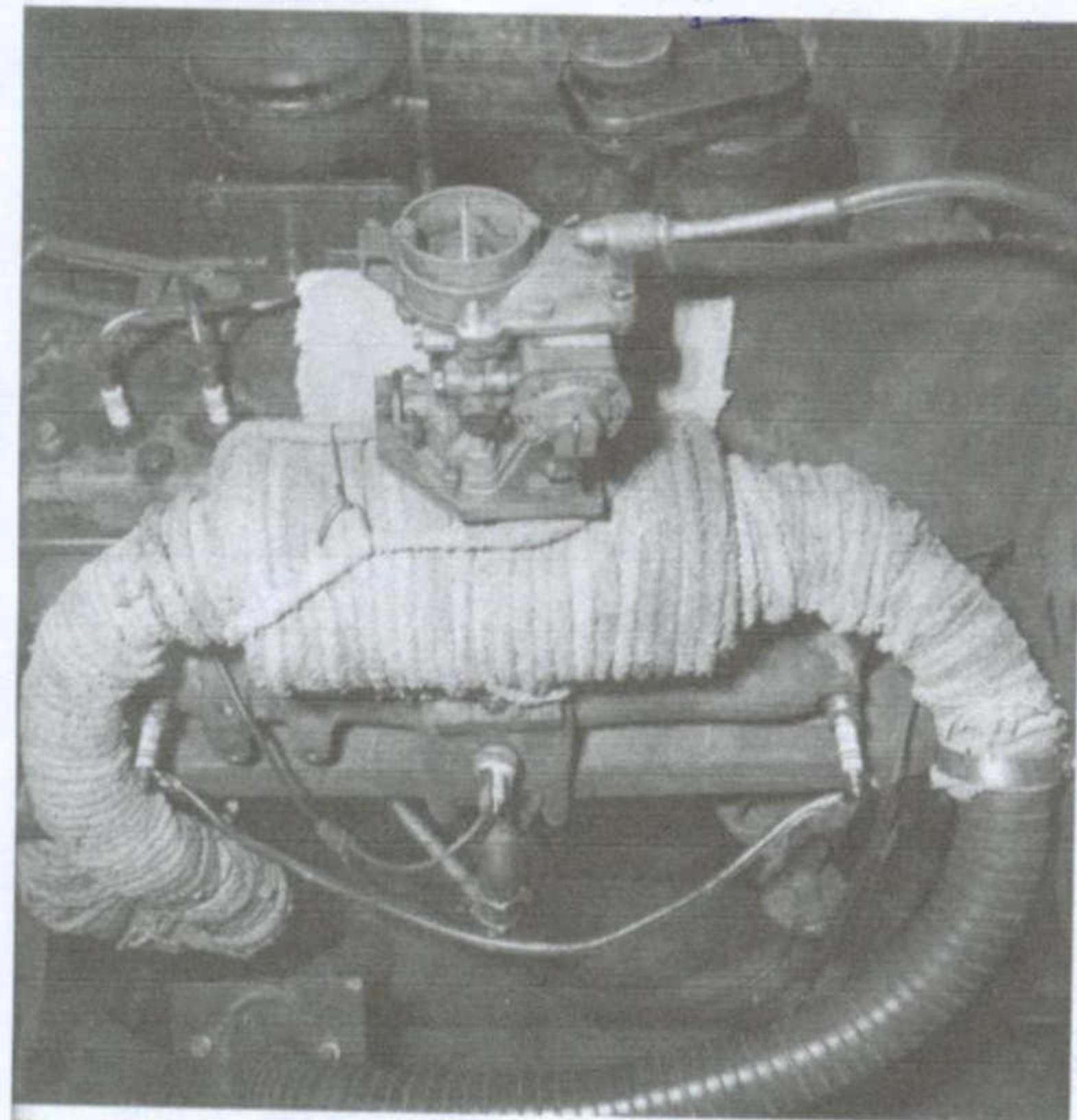
Un cordon d'amiante entoure la tubulure d'admission pour éviter les pertes de chaleur.
