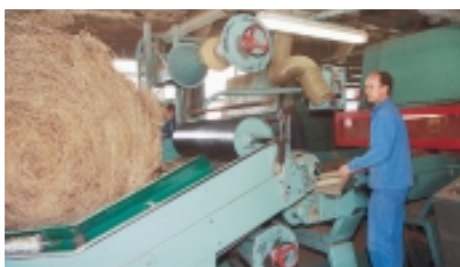
▲ Sur les chaînes de teillage, la paille est pressée puis battue pour récupérer la fibre.
