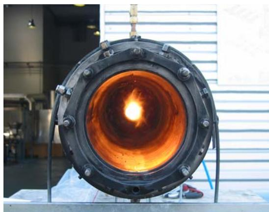
Brûleur du Module Chaud PACUTIL en fonctionnement au gazole à pression atmosphérique :  $f_{O_2} = 1.00$ ,  $P = 9.60$  kW
