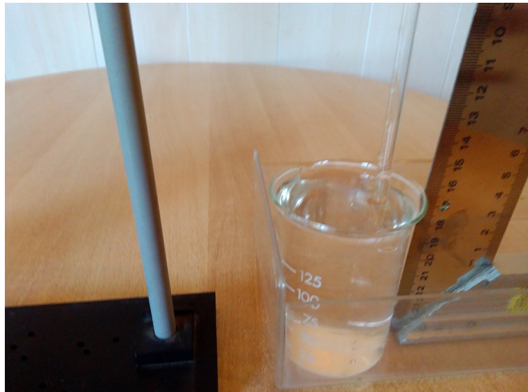
Figure 3 : évaluation de la hauteur d'ascension de l'eau dans un tube de diamètre 2mm
