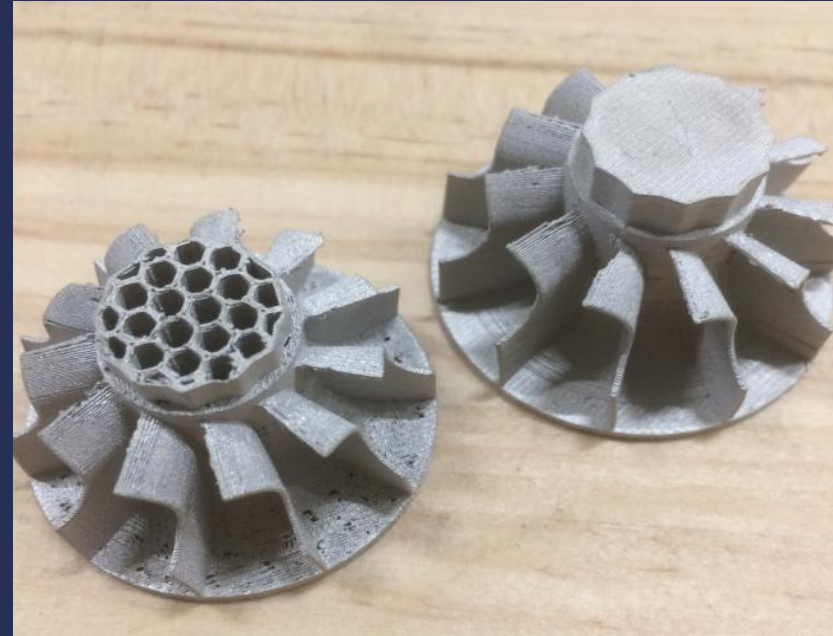
Turbine imprimée par imprimante filamentaire au CRITT
