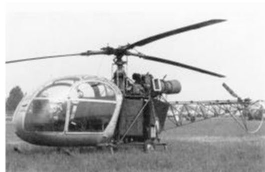
Le SE-3130 « Alouette II » 1 er hélicoptère à turbine français (1954). (Cliché EADS).
