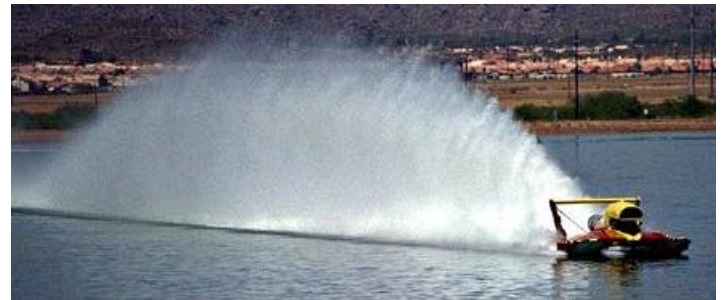
L'hydroplane U-55 (1995) à moteur à réaction, capable de plus de 300 km/h dans des courses en peloton sur des lacs américains. (Musée des hydroplanes).
