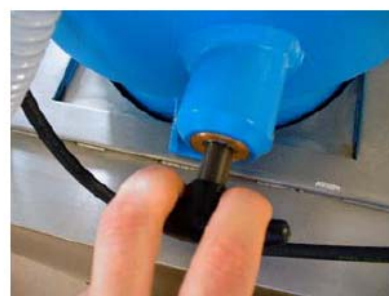
Figure 7 : Vanne d'arrêt des injecteurs : à gauche, fermée, à droite : ouverte
